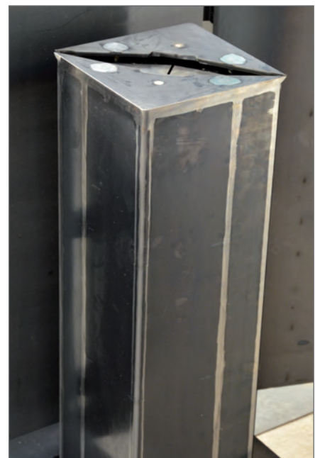
Die Dichtungen an der Schrumpfmehchanik verhindern auch ein Verschmutzen in der Schalung
