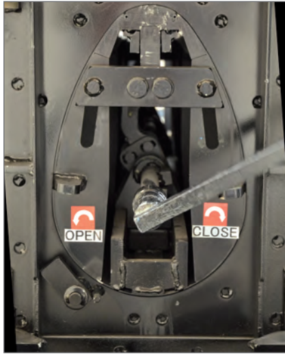
Öffnen der Exzentrerspindel mit Steckschlüssel
