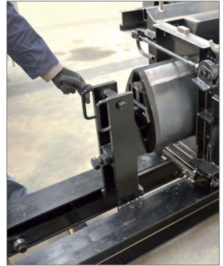
Laufrollengeführt wird der Innenkern herausgezogen
